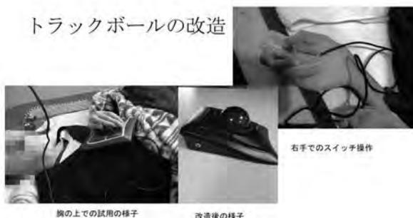
実際にこれが学校を訪問した時です。本人へ試したときに胸にトラックボールを置いて左手で回していました。何とかこれでできそうですけれど、実はクリック操作ができないのです。左クリックができないので、ここに左クリックできるように、外部スイッチでやれるように改造をしました。右手(のスイッチ)でクリック操作をします。
