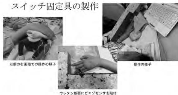
これが実際の例です。PPSスイッチで右手の薬指で操作をしていたのですが、動きが悪くなったので他の方法で何とかできないかということで、手のひらを上にして、PPSスイッチのピエゾセンサを固定するウレタン素材を使い、このウレタンに固定して操作をするようにした例です。
